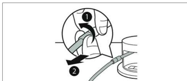
obr. 6.3 Uvolnění vakuovací hadice ze spojky
